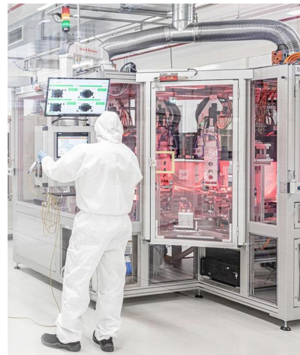
© Volkswagen AG / Abb. zeigt Anlage zum Stapeln von Elektroden
