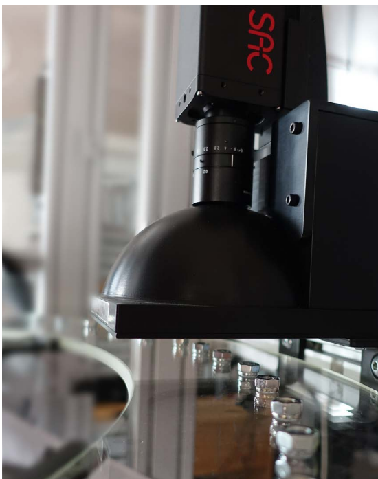
Die geprägten Schriftzeichen sind auf der konkav gewölbten Metallfläche über das Integrationsbild vollständig erkenn- und auswertbar.
